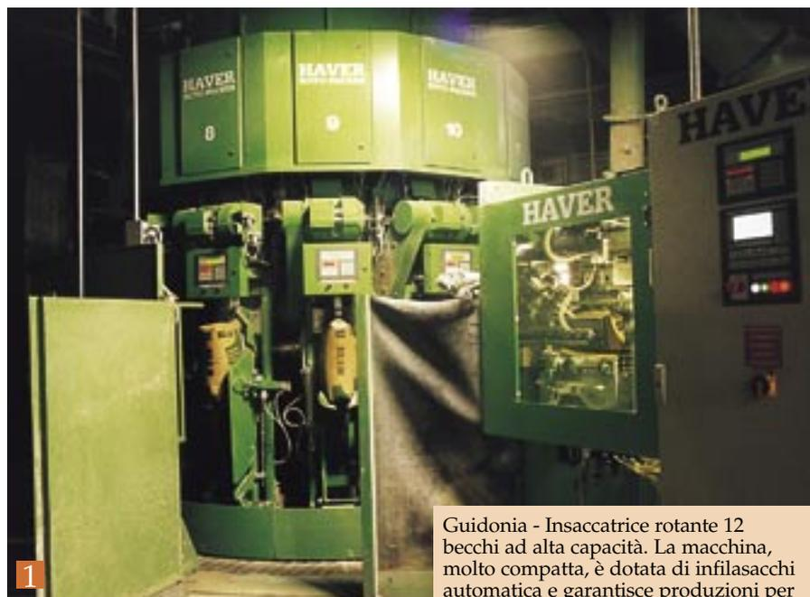
Guidonia - Insaccatrice rotante 12 becchi ad alta capacità. La macchina, molto compatta, è dotata di infilasacchi automatica e garantisce produzioni per le quali in passato erano richieste due insaccatrici. Inoltre, la pesatura elettronica consente un'accuratezza media dello 0,25% ed una correzione automatica del riempimento del singolo sacco.
