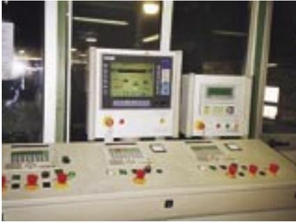
La console di comando dell'insacchitrice Geo 12 e del palletizzatore M40
