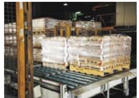
Il carico palletizzato, depositato sulla rulliera di prelievo, è pronto per essere caricato a magazzino oppure sull'automezzo
