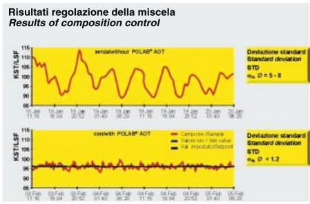
in funzione: la deviazione standard del Kst si riduce a valori inferiori a 1.2, un risultato in termini di costanza di qualità veramente eccezionale.
