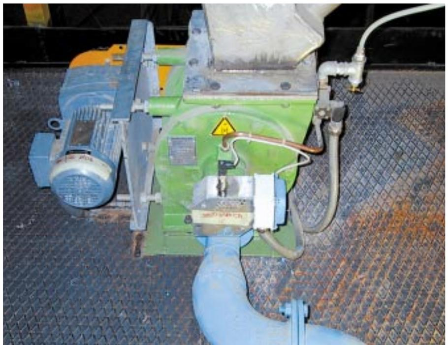
Vista dall'alto della rotocella che alimenta il bruciatore principale del forno di cottura del clinker a Travesio (Pn)
