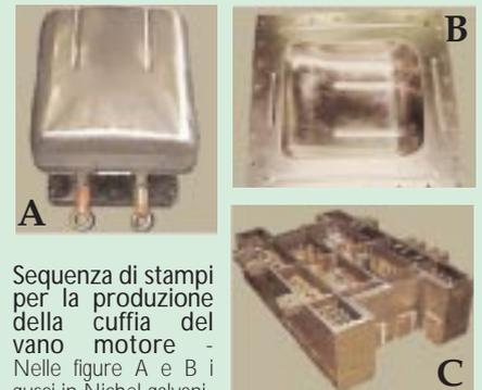
**Sequenza di stampi per la produzione della cuffia del vano motore** - Nelle figure A e B i gusci in Nichel galvanico per la produzione, rispettivamente, del punzone e della matrice: entrambi vengono riempiti con il KD5. Nella figura C, il basamento dello stampo sul quale viene fissato il guscio della matrice.
